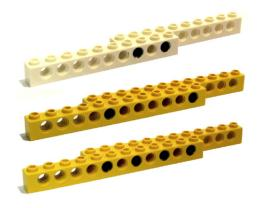
Cuando sea posible, son preferibles pins con fricción para la fuerza máxima, dado que sustituir los dos pins con fricción en esta última estructura, por dos axles 4L con casquillos (ver imagen) o por un par de pins sin fricción aumenta el desplazamiento en 0,2 mm, es decir, reduce la resistencia total en un 15%.
