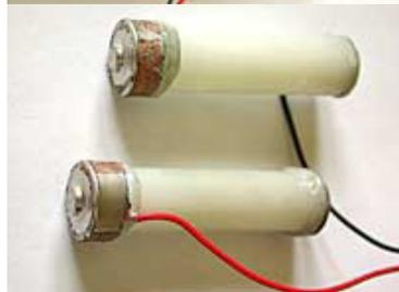
Las baterías falsas fueron ensambladas a partir de los extremos cortados de antiguas baterías alcalinas, mantenidas a la distancia correcta con barras de pegamento de fusión en caliente.
