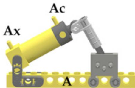
Es igualmente importante tener nombres para los puertos de la válvula. Cuando la palanca se mueve al extremo derecho, la presión que entra por el puerto central sale por el puerto izquierdo. En todos estos ejemplos esto sucede cuando el pistón que controla la válvula se expande. Para nuestros ejemplos el puerto más próximo al pistón se llama según el nombre de éste. En este ejemplo el pistón se llama A por lo que el puerto de la válvula más próximo al pistón también se llama A.
