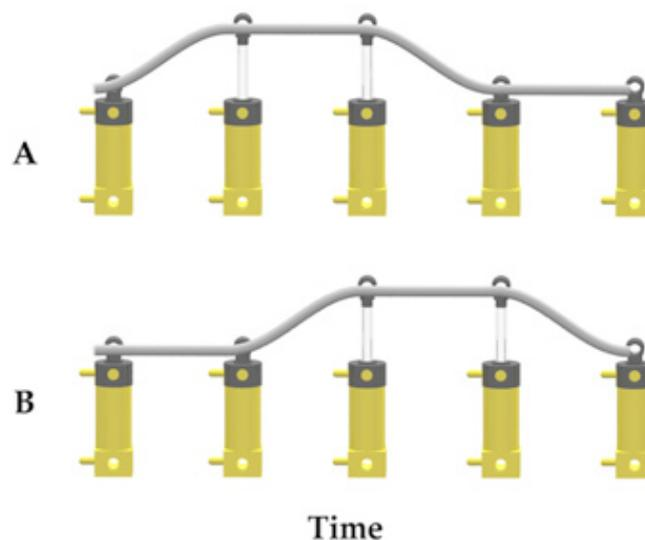
El gráfico muestra los estados de contracción y expansión de los pistones a lo largo del tiempo. Arriba se muestra el pistón A y la línea de abajo el pistón B. La línea inclinada hacia arriba representa la expansión del cilindro. Las líneas horizontales representan el estado estable del cilindro, sea contraído o expandido. La línea inclinada hacia abajo representa la contracción del cilindro.
