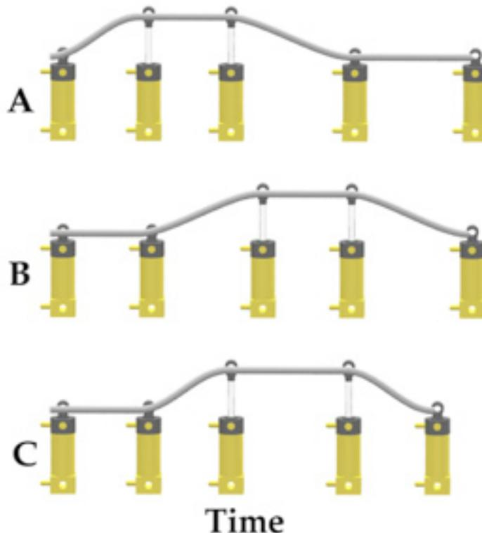
Observa que el pistón C no se comporta exactamente igual que el pistón B. Si intentamos usar los pistones B y C en un modelo de LEGO®, las partes controladas por estos dos pistones no se comportarían exactamente de la misma manera. Está claro que añadiendo más pistones al circuito de esta manera, no resultará en que los pistones B y C se comporten exactamente igual.
