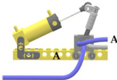
Cuando la palanca de la válvula se mueve al extremo izquierdo, la presión que entra por el puerto central sale por el puerto derecho. En todos estos ejemplos esto sucede cuando el pistón que controla la válvula se contrae. Para nuestros ejemplos, el puerto más alejado del pistón se indica con una tilde, seguida del nombre del pistón. Puedes usar la palabra “no” al leer  $\sim$ . Para el ejemplo que sigue, el pistón está contraído por lo que la presión sale por el puerto “no A”.
