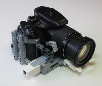
Hecha la base, el segundo paso es construir pequeñas paredes unidas por estructuras verticales que sujetarán a la cámara. Nota que no hace falta que rodeen la cámara por completo, sino solo algunas esquinas opuestas. Nuevamente se pueden usar Technic frames puestos en vertical, pero la tarea principal de ese paso es identificar dónde se pueden colocar piezas curvas que encajen con la forma de la cámara.
