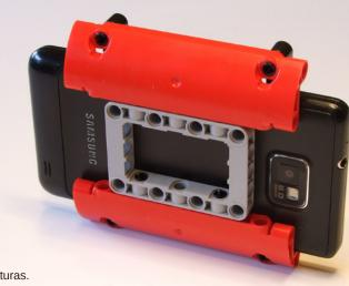
Los teléfonos inteligentes pueden sujetarse fácilmente usando paneles y estructuras.
