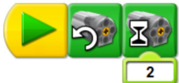
En Scratch se puede programar de forma similar. Al utilizar la opción de “al presionar bandera” bajo el menú de Control. Luego es necesario ir al menú de Movimiento, seleccionar el bloque de motor en este sentido, seleccionar el bloque de “motor encendido por \_\_ segundos”, y escribir 0,2 dentro de la casilla de tiempo.
