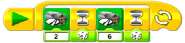
El código de programación en Scratch puede ser como se muestra a continuación. Los comandos a utilizar están dentro de los menús de Movimiento (poder del motor), Control (para los ciclos y comandos de esperar) y Operadores (para el número al azar).
