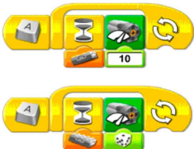
La programación en Scratch se vuelve un poco desafiante porque no aparece una imagen con la dirección de inclinación. El sensor de inclinación tiene 5 valores diferentes (del 0 al 4). Nivelado es 0, hacia abajo es 1, girado hacia la derecha es 2, hacia arriba es 3 y girado hacia la izquierda es 4.
