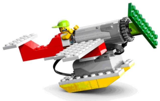
Cuando se pulsa la Tecla "A" nuestro programa inicia, y dependiendo de la dirección del sensor de inclinación este hará que el motor gire a la máxima potencia si está subiendo o tenga fallas de motor al azar si está bajando. Todo dentro de un bucle de programación para mantener el programa corriendo siempre.
