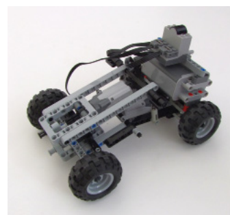
Ruedas motrices traseras y dirección frontal es la configuración más común y es fácil y rápido de construir con pocas piezas.
