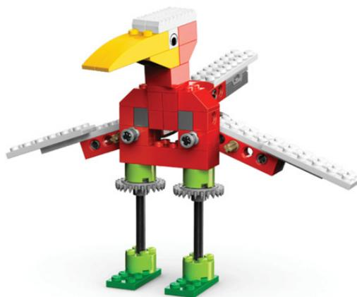
En WeDo la programación puede usar tanto el sensor de inclinación puesto en la cola del pájaro o el de distancia en los pies del pájaro según se muestra.
