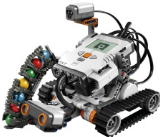
2 ruedas motrices, como en este robot oficial 8547, permite un giro muy pequeño, pero la dirección es poco precisa con mucho derrape.
