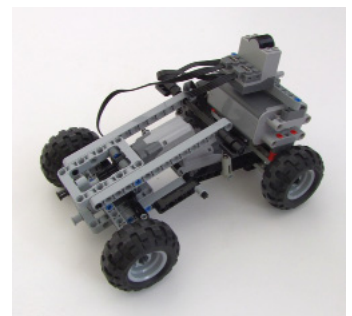
Ruedas motrices traseras y dirección frontal es la configuración más común y es fácil y rápido de construir con pocas piezas.
