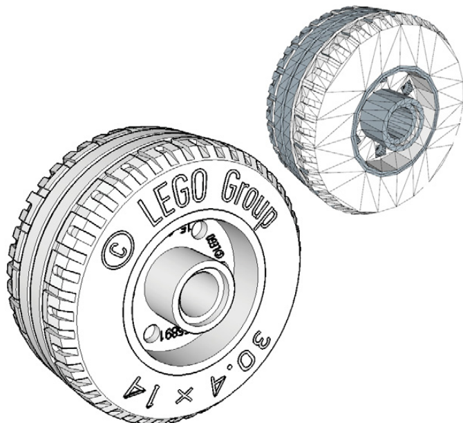
Fig. 4. Comparación entre un elemento importado (izquierda) y la versión remodelada de mi biblioteca (derecha). El nivel de detalle que añadí en este neumático incluye el número del elemento y el logo de LEGO.
