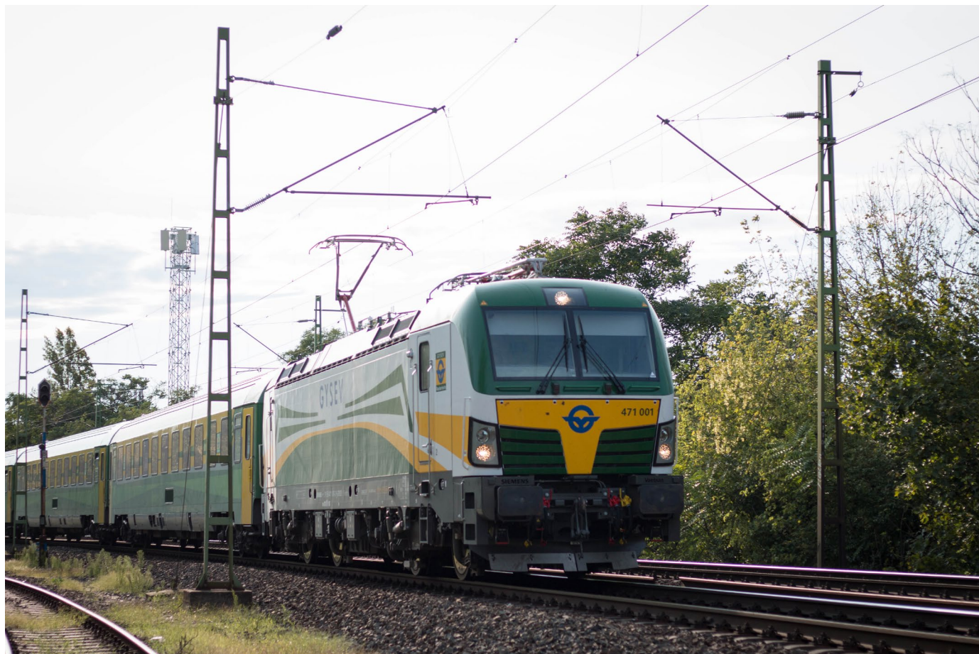
Fig.1: Locomotora Siemens Vectron de doble voltaje con los colores de GySEV/ROeEE
