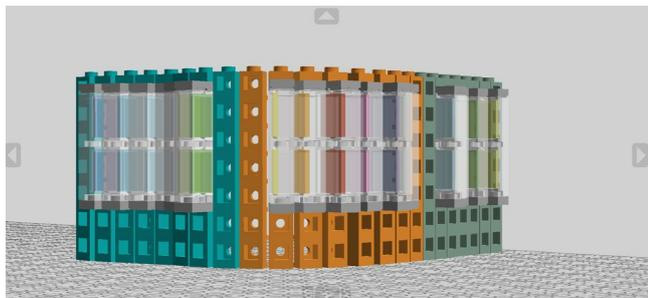
La segunda iteración de diseño se acerca mucho más al diseño final que el primero. Los cambios que hice fueron estrechar las ventanas y las líneas de color, además de hacerlas continuas hasta el tejado. La diferencia recae en la forma de las ventanas (aquí horizontales las unas de las otras) y la forma del tejado. Anotad que el edificio azul aquí ya estaba terminado, pero parece un poco pequeño al lado del monstruo de al lado.
