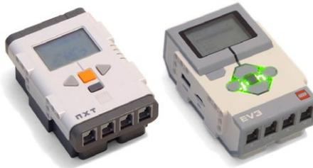
Nada impide conectarse y controlar múltiples ladrillos NXT y EV3 simultáneamente. Pero ten en cuenta que tendrás que configurar los puertos serie para cada uno de estos Smart Brick individualmente.
